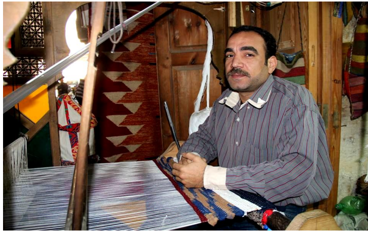
صورة رقم (٣ أ) صناعة الكليم بالقاهرة (شارع الخيامية) على النول الأفقي
