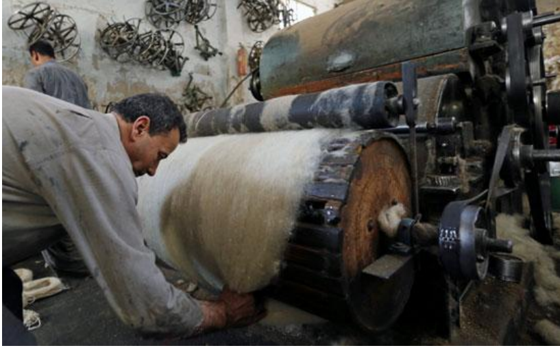
صورة رقم (٨) تهيئة الصوف في الماكينات لاستخراج الخيوط(اخميم)
